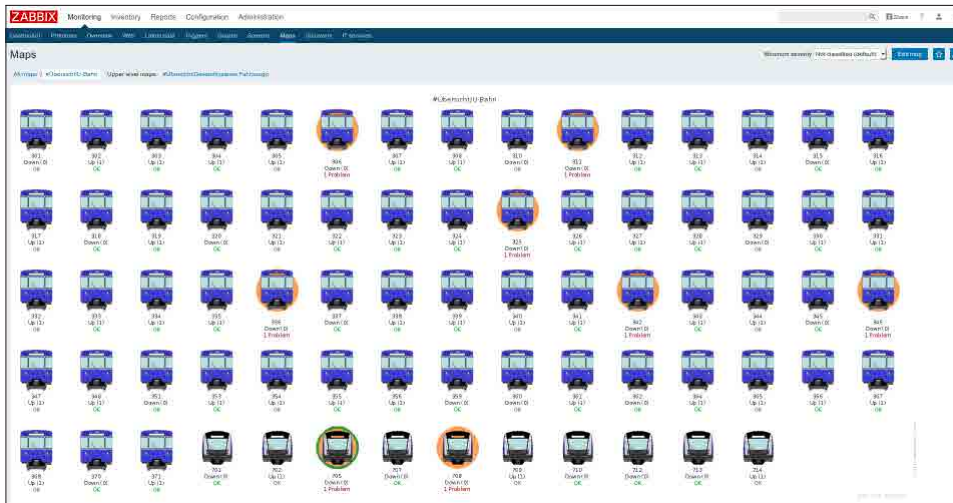
Web 기반 Dash-Board : 독일 Munich Transport Corporation 예시 '통신장애가 발생한 기차'에 대해 알람으로 알려준다
