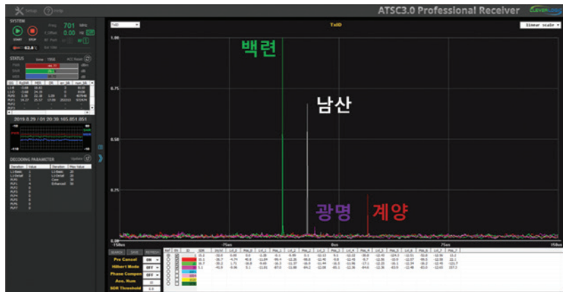
그림 7. 송신기 식별부호를 활용한 지상파 UHD 방송망 성능분석 결과
