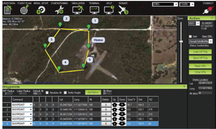
그림 4. 자율비행 드론의 경로 지정 예시 / 출처 : Ardupilot.org
