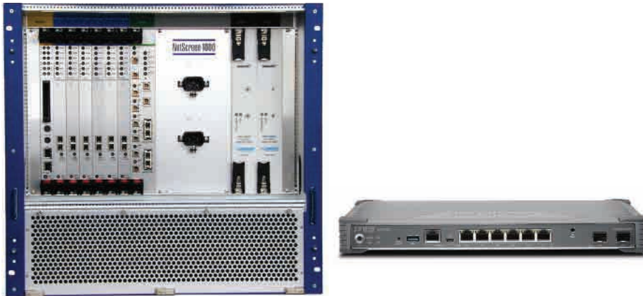
그림 1. 최초의 Giga 급 방화벽(Netscreen 1000)과 동일 성능의 최신 방화벽
