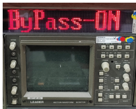
Bypass 시 표시되는 디스플레이(주조중실 시스템관리자 제작) / GPIO 케이블 결선
