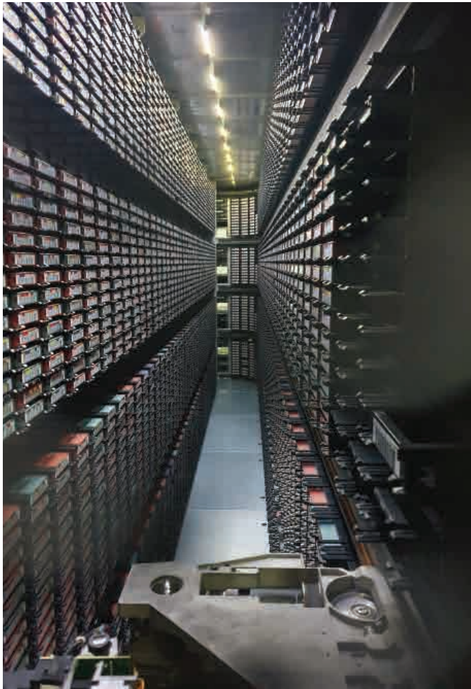
그림 4. 다량의 LTO가 저장된 테이프 라이브러리 내부
