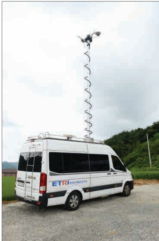
ETRI가 구축한 UHD 방송신호 측정 차량
