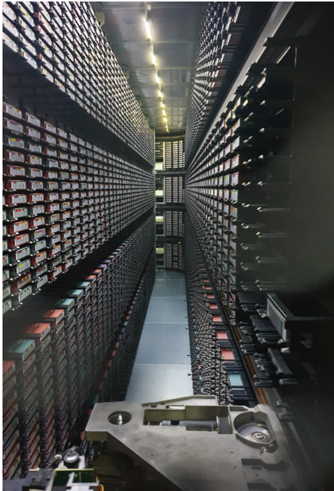
그림 4. 다량의 LTO가 저장된 테이프 라이브러리 내부
