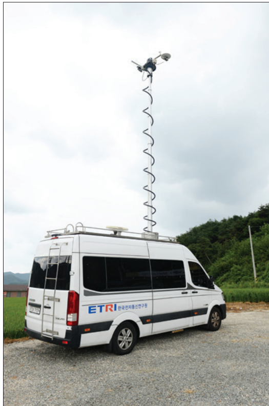
ETRI가 구축한 UHD 방송신호 측정 차량
