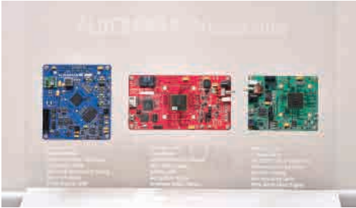
ETRI 연구진이 개발한 인공지능 반도체 칩, '알데바란' 프로세서가 적용된 기판
