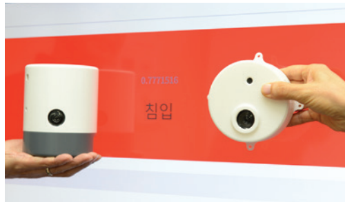
ETRI 연구진이 개발한 음장보안센서와 관제 모니터 침입 알람
