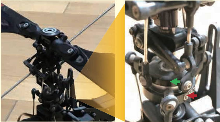
그림 4. 스와시 플레이트와 메인 로터 연결 링크
