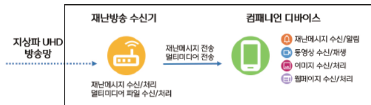
그림 3. 세컨드 디바이스 연동 재난방송 서비스 구성도
