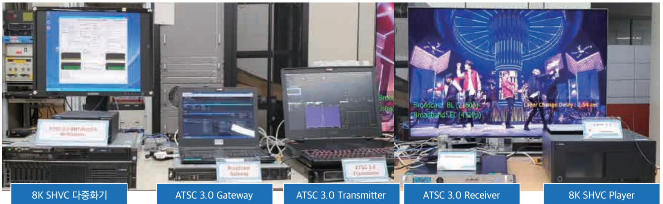
그림 8. 융합 전송망 기반 스케일러블 8K-UHD 서비스 송수신 플랫폼
