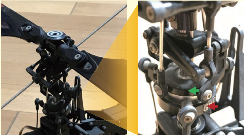
그림 4. 스와시 플레이트와 메인 로터 연결 링크
