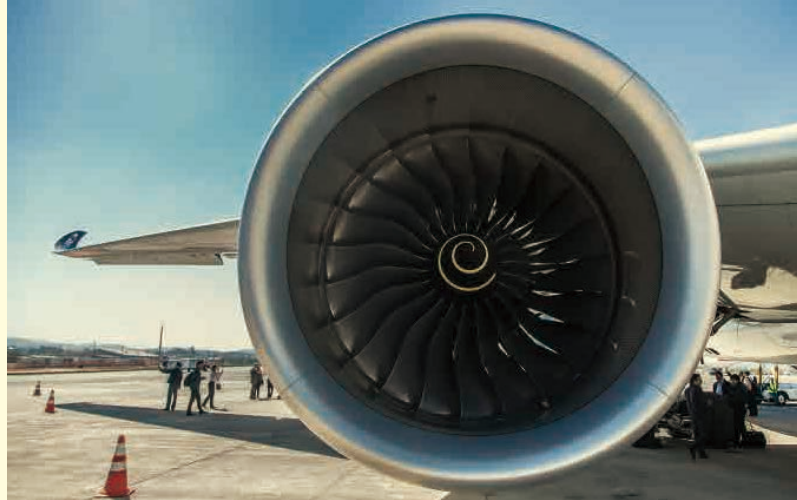
그림 6. 터보-팬 제트 엔진의 팬 / 출처 : www.boldmethod.com
