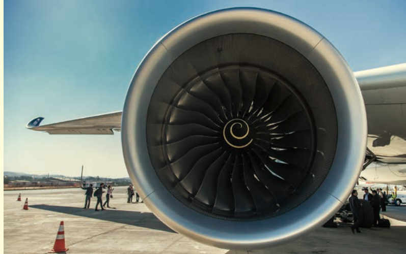
그림 6. 터보-팬 제트 엔진의 팬 / 출처 : www.boldmethod.com
