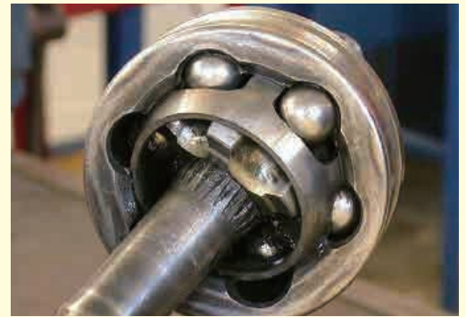
그림 7. 자동차용 등속 조인트 가동 범위 / 출처 : youramazingcar.com
