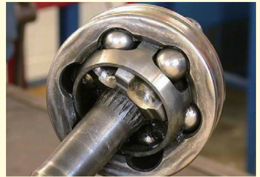
그림 7. 자동차용 등속 조인트 가동 범위 / 출처 : youramazingcar.com
