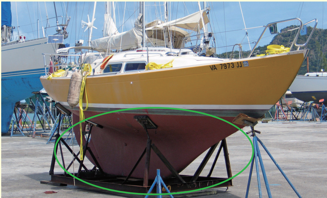
그림 4. 용골(Keel) / 출처 : www.sailmagazine.com
