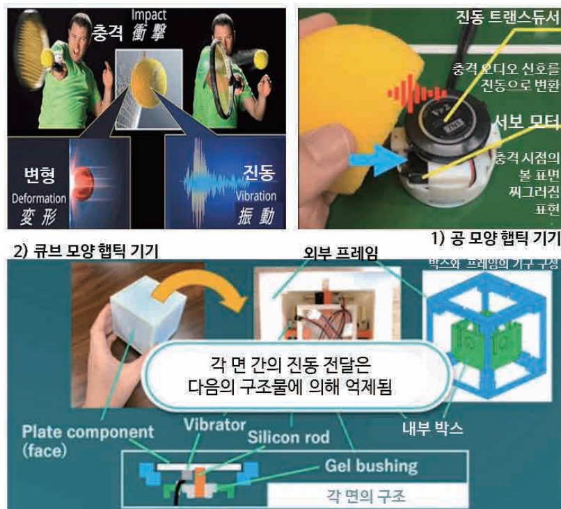
그림 11. 햅틱 기기의 구성 및 동작 원리
