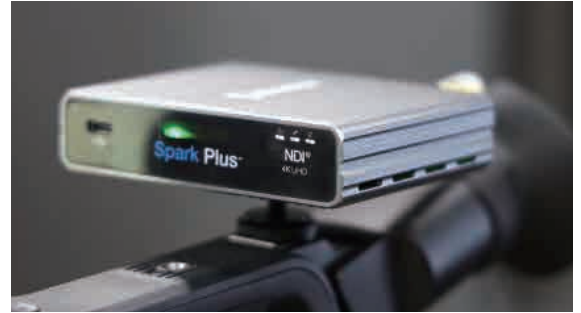
카메라 영상을 HDMI → NDI 방식으로 컨버팅해주는 Spark Plus
