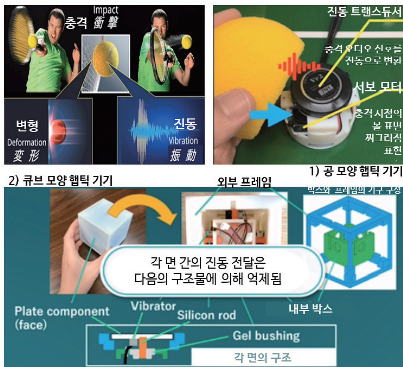
그림 11. 햅틱 기기의 구성 및 동작 원리
