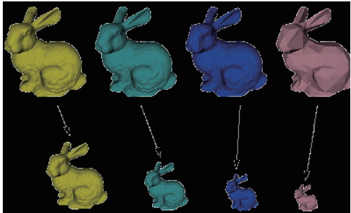
LOD 구현의 예, Levels of Detail & Polygonal Simplification
