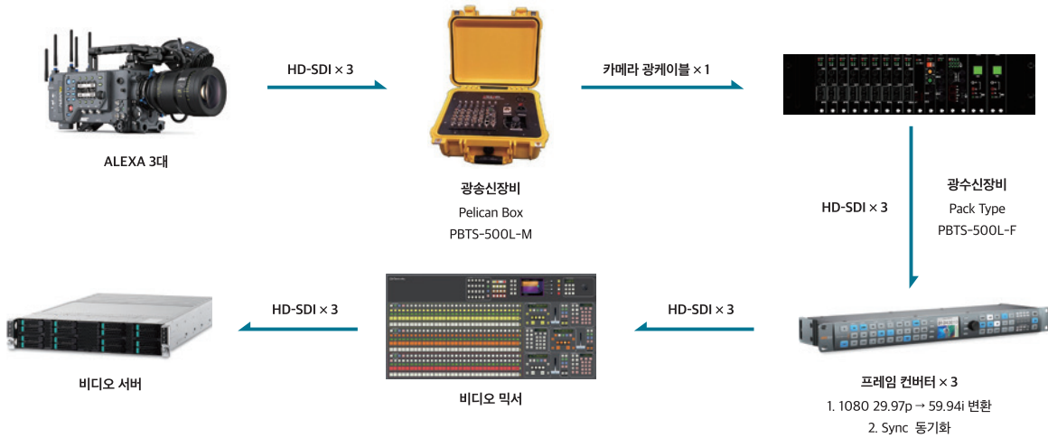
그림 2. 스튜디오 시스템 구성
