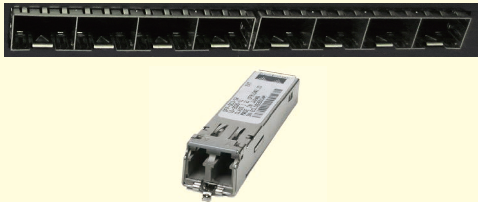
그림 8. SFP(Small Form-factor Pluggable) 모듈
