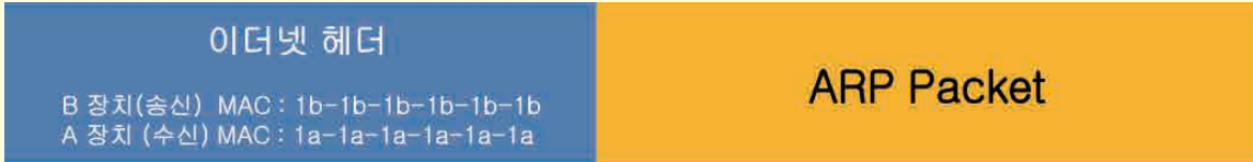
그림 3. B 장치에서 송신하는 ARP Reply
