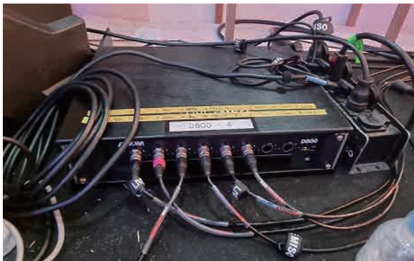
그림 9. Aviom Personal Mixer. 악단 개인당 하나씩 지급했으며, Dante 포맷으로 데이터를 전송한다.
