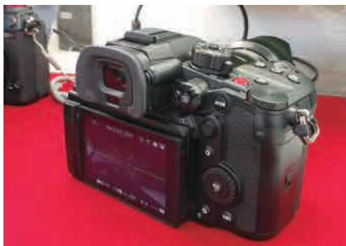
루믹스 GH6 좌, 우측. 쿨링팬이 추가되어 기존 GH5 대비 폭이 살짝 늘어났지만 오히려 손에 쥐기엔 안정적인 느낌이었다
