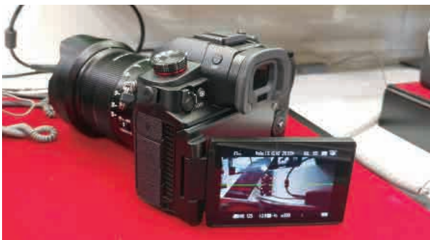
루믹스 GH6 좌, 우측. 쿨링팬이 추가되어 기존 GH5 대비 폭이 살짝 늘어났지만 오히려 손에 쥐기엔 안정적인 느낌이었다
