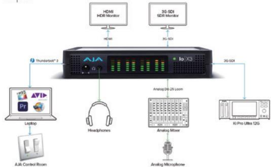
Io X3는 Apple Final Cut Pro 및 Avid Media Composer, Adobe Premiere를 비롯한 모든 주요 NLE 애플리케이션에 대한 광범위한 지원을 제공하며 (NLE 워크플로우 디아어그램에 표시된 것처럼 실용적이고 사용하기 쉬운 기능을 제공합니다.) Io X3는 NLE 워크플로우의 중심에 위치하며 초고속 Thunderbolt 3을 통해 호스트 노트북에 직접 연결됩니다. NLE 소프트웨어는 HDR 및 SDR 모니터링을 지원하는 HDMI 포트와 3G-SDI 포트 통해 동시에 타임라인 출력이 표시되며 출력과 함께 사용자 노트북에서 실행됩니다.
