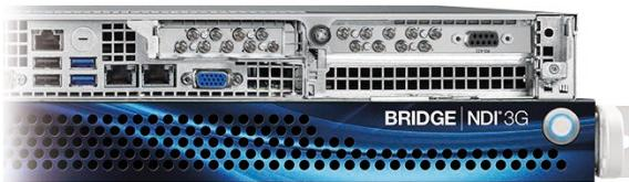
BRIDGE NDI 3G는 소형 1RU에 들어 있지만 모든 베이스 밴드 비디오 입력 및 출력을 위한 소형 DIN 1.0/2.3 스피곳으로 16개의 양방향 3G-SDI 커넥터가 있는 고성능 I/O를 제공합니다. BRIDGE NDI 3G에는 18x DIN 1.0/2.3 - BNC 커넥터가 포함되어 있어 기존 SDI 인프라에 쉽게 설치할 수 있으며, 제어 및 모든 NDI I/O를 위한 듀얼 10GigE 포트를 자랑하여 최대 16채널의 수신 또는 발신 NDI 스트림을 지원합니다.
