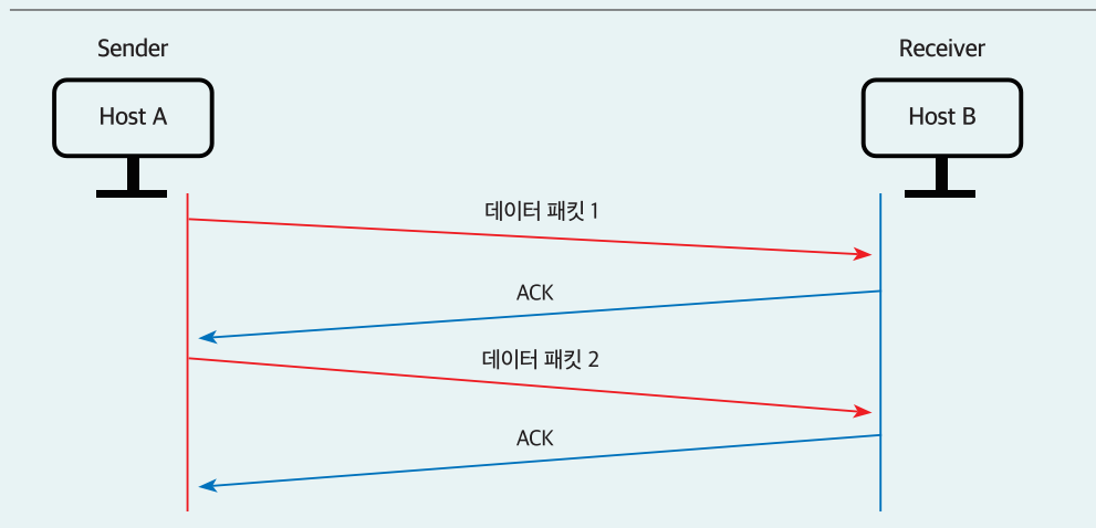
그림 1. Stop & Wait에서의 ACK 메시지와 패킷 전송
