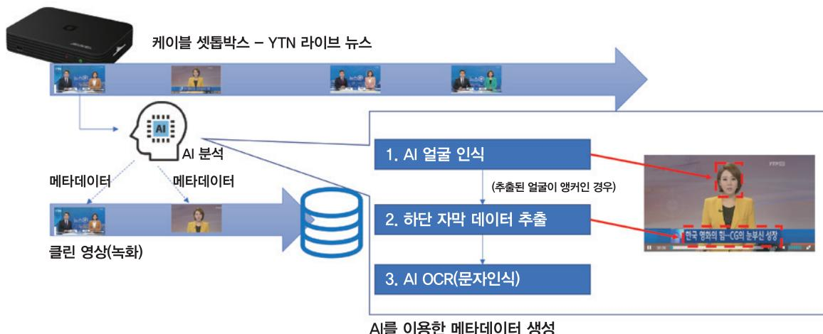
아리랑TV에서 금번에 개발한 AI RF Titling은 얼굴인식과 OCR이라는 AI 기술과 카탈로깅 및 실시간 영상분석의 기술을 이용하여 개발되었다. AI RF Titling의 기술은 케이블 및 공중파로 들어오는 영상을 AI 엔진이 분석하여 비디오서버로 입수한 클린(Clean) 영상에 매치(Match)시키는 것이다. 기술을 간략하게 소개하면, 녹화하는 영상에서 장면 전환 지점을 확인하다가 키 프레임 중에 AI로 얼굴을 인식하여 앵커가 나타나면 새로운 뉴스로 판단하고, 자막에 입력된 데이터를 OCR(문자인식)하여 메타데이터로 등록하는 기능이다. 해당 기술에서 AI 얼굴인식과 AI OCR은 모두 대형 클라우드 업체의 SaaS 서비스를 쓰지 않고 자체적으로 개발하여 On-Premise로 추가적인 비용이 들지 않는다는 것이 특징이다.
