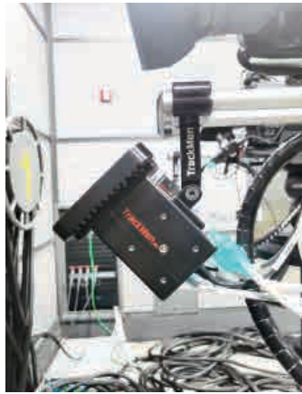
그림 9. 카메라에 부착된 트래킹 카메라
