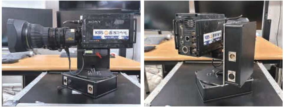
그림 13. 구현된 사물 인식 자동추적 카메라시스템
