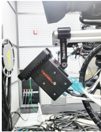
그림 9. 카메라에 부착된 트래킹 카메라
