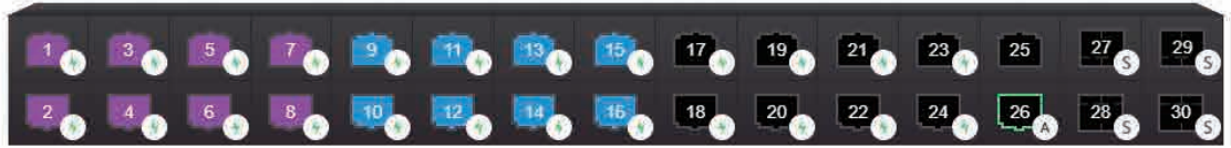
VLAN 기능을 이용한 네트워크 스위치 포트별 분리
