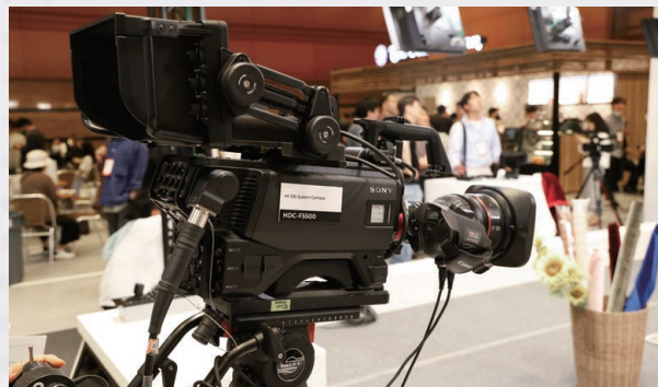
4K 및 HDR을 지원하는 2/3인치 3CMOS 이미지 센서를 탑재한 HDC-5500
