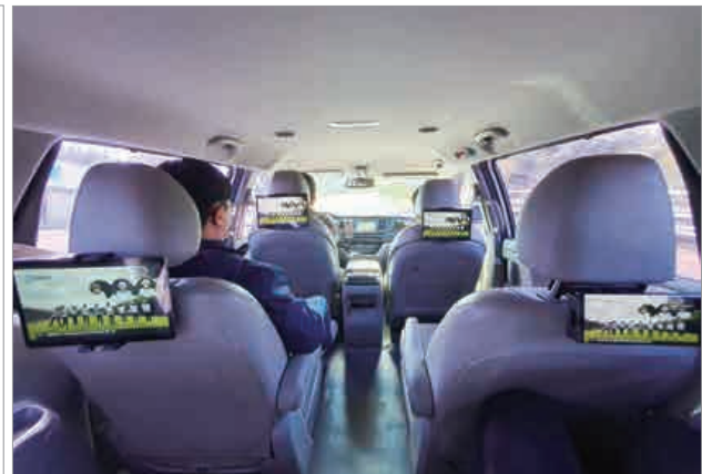
그림 3. (좌) 모바일 DNS 기반 방송망-통신망 연동을 위한 '이어도' 시스템 구조 (우) 필드테스트 검증용 차량 내부 각 좌석에 ATSC 3.0 직접수신 단말기를 거치한 모습
