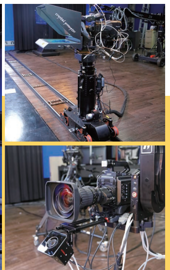
TS-6 XR 스튜디오의 카메라와 트랙킹 장비 연동
