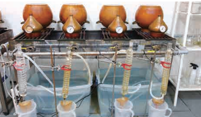
냉각기를 제거하고 유리관을 설치한 동증류기
