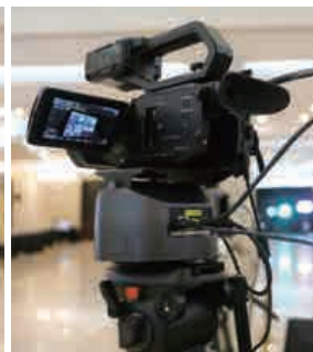
TVS-2000A, 트래킹/트랙리스 가상 스튜디오 시스템
