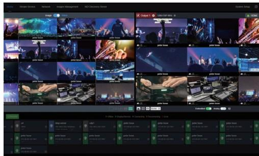
D350 멀티 디코더는 최대 16채널의 멀티뷰어를 생성하고 이를 9개의 멀티뷰어 스크린으로 구성하여 출력할 수 있습니다. D350에 다양한 프로토콜의 디코딩 IP 소스를 등록하여 멀티 뷰어에 적용시킬 수 있으며 생성된 멀티뷰어 역시 다이내믹 전환을 통해 사용자에게 최적화된 화면 구성을 제공합니다. 멀티 뷰어 출력 역시 D350에서 제공하는 HDMI 2.0 출력 또는 3G-SDI 출력으로 선택하여 내보낼 수 있으며, 출력 인터페이스의 해상도와 프레임레이트에 따라 사용자가 원하는 해상도를 직접 지정할 수도 있습니다.
