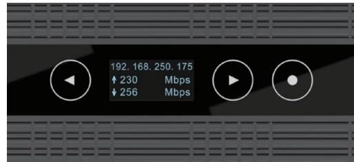
그동안 IP 기반으로 동작하는 장비를 설정할 때 가장 답답했던 부분은 바로 IP 정보와 설정 값을 장비에서 직접 확인할 수 없다는 것이었습니다. Kiloview의 새로운 멀티 디코더는 D350은 장치에 부착된 LCD 화면을 통해 IP 정보와 장비 동작 상태를 직접 확인할 수 있어 사용자의 편의성을 극대화합니다. 또한 터치로 동작하는 버튼은 직관적으로 장치를 조작할 수 있게 합니다.
