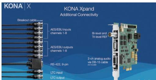
KONA Xpand는 KONA X의 연결 옵션을 확장하는 PCIe 카드입니다. 바이 레벨/트라이 레벨 비디오 레퍼런스는 물론 다양한 장치를 제어하기 위한 9핀 RS-422 커넥터, 8채널 언밸런스 AES/EBU 오디오 I/O, KONA Xpand와 함께 제공되는 브레이크아웃 케이블의 LTC 입/출력 기능을 제공합니다. 사용자가 제공한 DB15 케이블을 통해 2채널의 밸런스드 아날로그 오디오 I/O도 사용할 수 있습니다.
