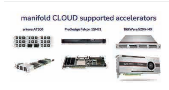
그림 7. manifold용 FPGA 가속보드 - 서버
