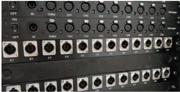
그림 15. DMX Patch 및 Splitter
