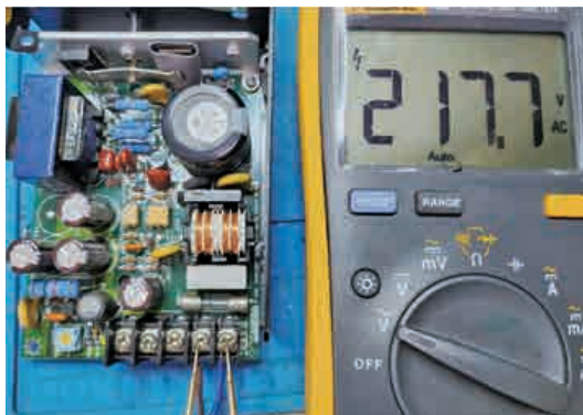
그림 14. 입력 전원 측정(220V AC)
