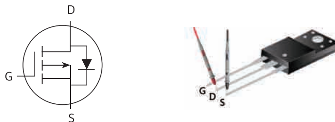
그림 18. P-Channel MOSFET 순방향 측정
