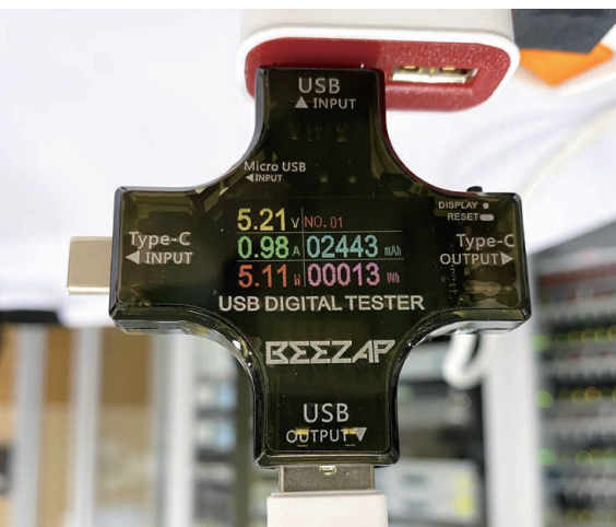
그림 7. USB 전압 테스트기로 확인한 라즈베리파이 4B 소모 전력
