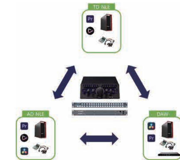
그림 10. 서버별 설치 SW와 I/O 인터페이스 비디오 라우터와 오디오 셀렉터로 상호 주/예비 역할 가능
