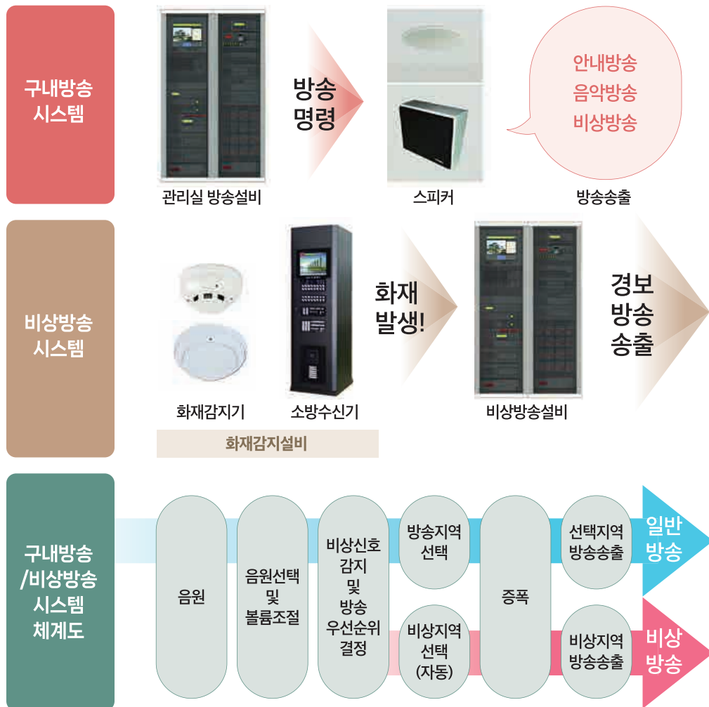
그림 9. 건축물에 설치되는 구내방송시스템 계통도
