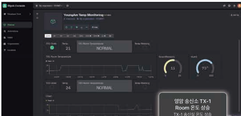
그림 3. PC 감시 화면(Blynk Console)
