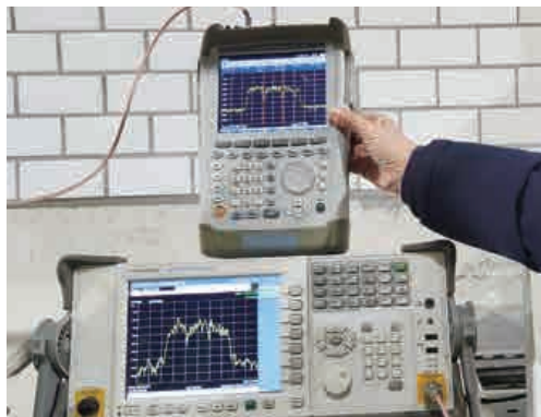
터널 내 DMB 측정(45dBuV 이상)
