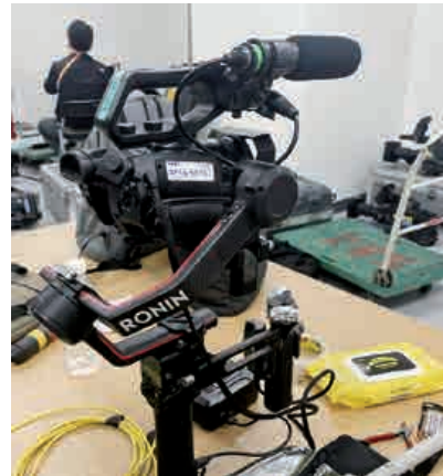
그림 18. 짐벌 카메라에 수신기 장착
