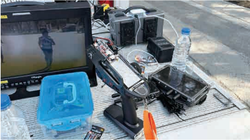
그림 16. 2024 경주마라톤 RC-CAR 조종기에 Tally 수신기 부착
