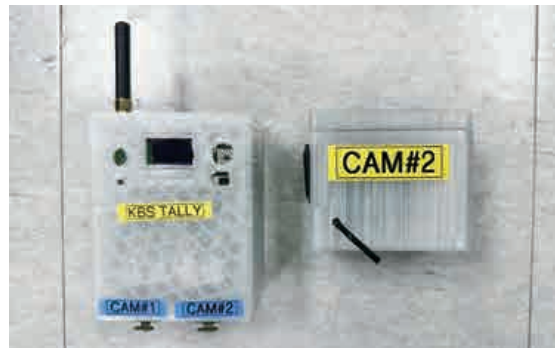
그림 1. Lora를 이용한 Tally 장치
