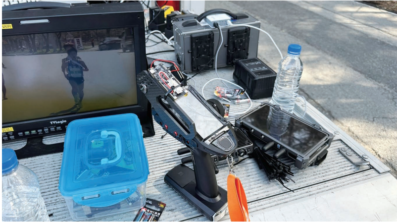
그림 16. 2024 경주마라톤 RC-CAR 조종기에 Tally 수신기 부착
