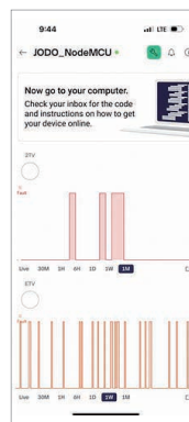
그림 10. Blynk 서비스를 이용한 스마트폰과 PC 혼신 발생 감시 화면
