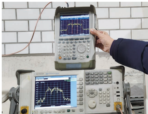
터널 내 DMB 측정(45dBuV 이상)
