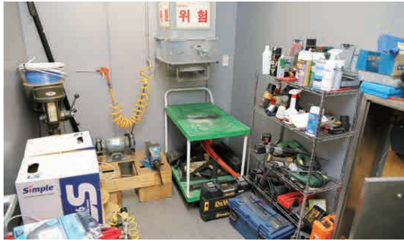
정비실 한쪽의 특수공구실, 철판에 구멍을 뚫거나 필요한 가공을 가능하게 한다
