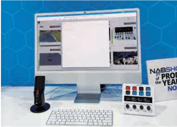
Lawo의 COTS 서버 기반 코멘터리 솔루션. 별도의 하드웨어 없이 서버 내에서 애플리케이션 기반으로 동작하는 솔루션
