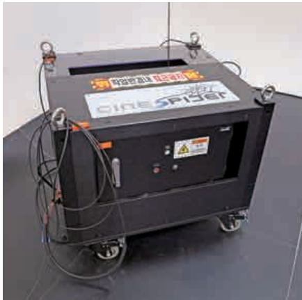
특수 광케이블을 사용하여 4축을 지탱하고, 카메라의 위치정보를 전달하는 원치
