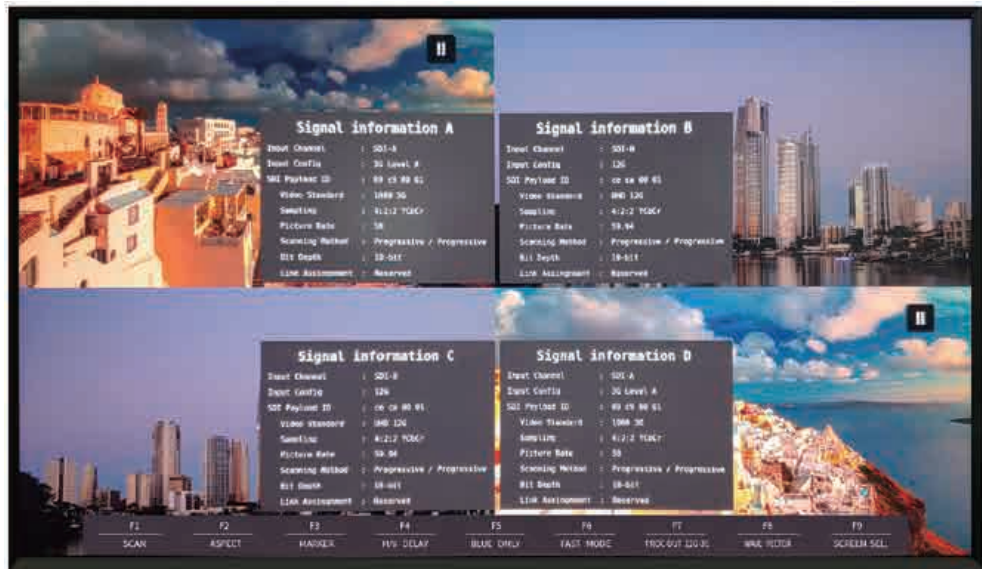
Quad View 상태에서 INFO Button을 누르면 사분할 화면의 영상 신호 정보가 나타나며, 동시에 Function Button에 현재 어떤 기능들이 지정되어 있는지도 확인이 가능하다
