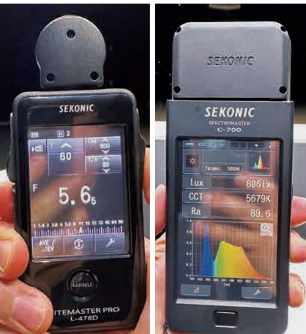
그림 27. 현장 조도 및 노출계를 통하여 조명 데이터값 체크
