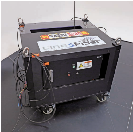
특수 광케이블을 사용하여 4축을 지탱하고, 카메라의 위치정보를 전달하는 윈치
