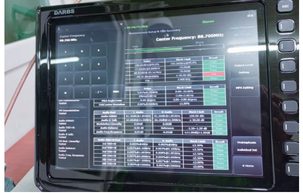
그림 32. FM 신호분석기를 활용한 송신기 종합특성 측정
